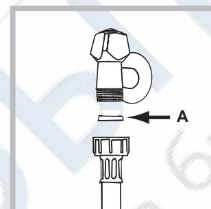
2. Вставьте прокладку A в конец заливного шланга и наверните его на вывод водопровода холодной воды с резьбовым отверстием 3/4 дюйма (см. рис.).
