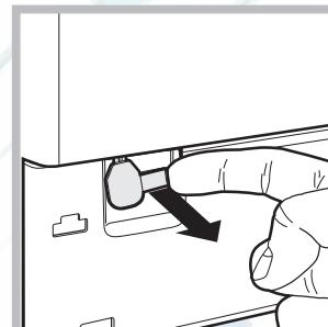
4. потяните наружу язычок, показанный на схеме, вплоть до освобождения пластикового блокировочного винта. Затем потяните его вниз, пока не услышите щелчок, что означает разблокировку люка.
